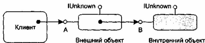
**Рис. 13.21.** Повторное использование COM-объекта с помощью включения
