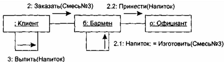
Рис. 12.17. Поток синхронных сообщений
