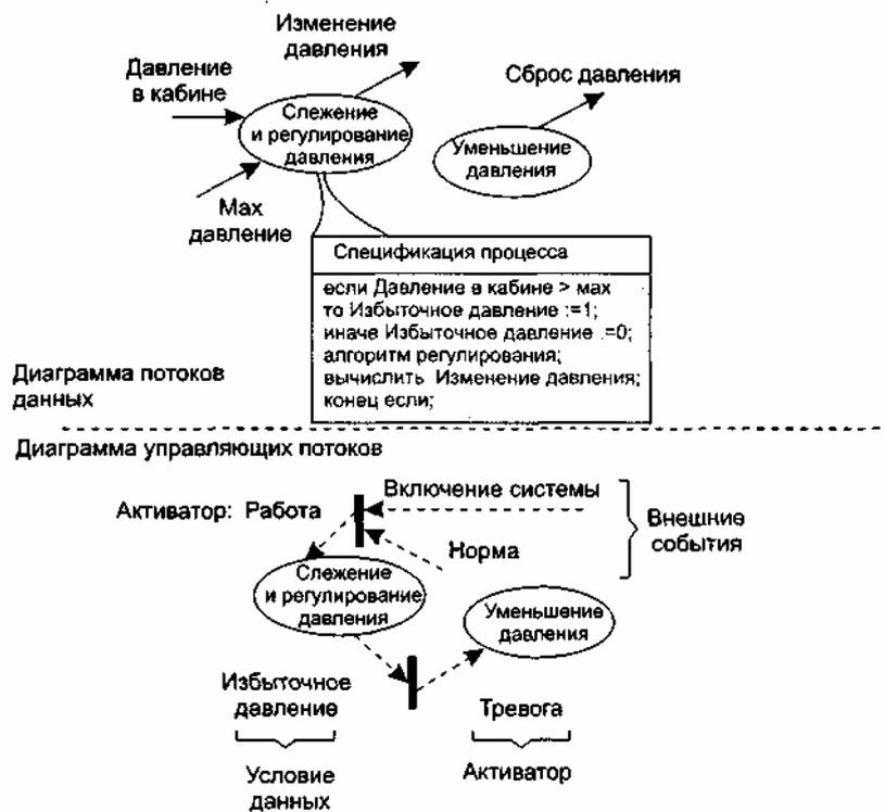
Рис. 3.9. Модель системы регулирования давления космического корабля
